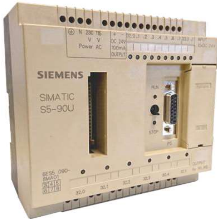
شکل (۴-۱۹) کنترل کننده منطقی S5-90U ساخت زیمنس
